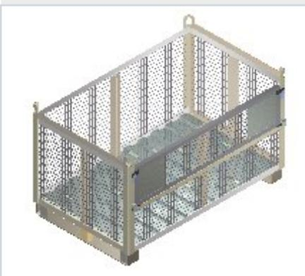
Контейнеры выполнены из стальных профилей и сетки. Корзина типа А полностью сварная, оборудованная откидным бортом, а корзина типа F (сетчатая) имеет возможность полного складывания стенок, что значительно уменьшает пространство, необходимое для хранения пустых корзин.
