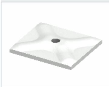
Штампованная стальная шайба предназначена для передачи напряжения, возникающего в результате давления бетона с пластин, посредством гайки на опалубочные стяжки. Специальная штамповка на поверхности шайбы увеличивает ее прочность. Антикоррозионную защиту шайбы обеспечивает цинковое покрытие.
