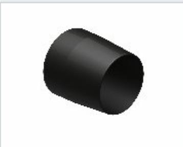
Пробка STOPF - это пластиковая заглушка для герметизации наконечников IN. Пробка STOPF защищает переход по опалубочной стяжке при небольшом давлении воды от попадания ее на другую сторону бетонного элемента. Вместе с пробкой FLUPP являются эффективной защитой от проникновения дождевой воды на другую сторону бетонного элемента.
