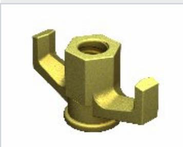
Барашковая гайка отлита из ковкого белого чугуна, резьба гайки соответствует стандартной резьбе стержней. С гайкой необходимо использовать прижимную шайбу. Имеет гальваническое покрытие, что существенно удлиняет срок службы. Навинчивается на стяжку ключом для барашковых гаек, ключом с храповиком или торцевым ключом.
