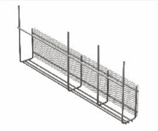
Однокомпонентная BESTAL используется в качестве рабочего шва в искривленных местах (по дуге). Лента, уплотняющая рабочий шов, вставляется между вертикальными стержнями. Смещение стержней составляет около 15 мм.
