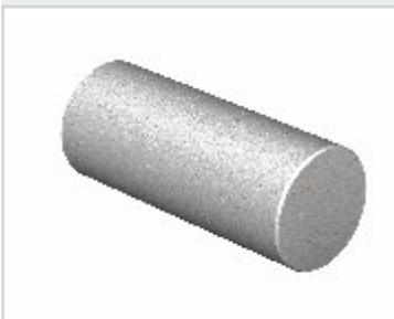
Бетонная пробка используется для герметизации распорных бетонных труб, вклеивается с помощью двухкомпонентного клея А + В. При воздействии напора воды герметичность системы на базе трубы FB составляет 25 м водяного столба. При монтаже полезным окажется устройство для установки пробок, с помощью которого сначала в бетонную трубу необходимо установить пробку ПВХ. Пробка ПВХ выступает в качестве упорного ложа для вклеиваемой бетонной пробки FB. Расход клея составляет около 150 пробок/кг.
