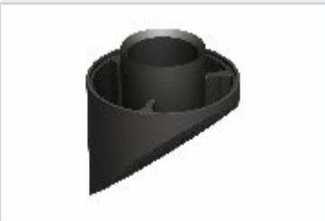
Заглушка для конуса МКК изготовлена из пластика. Заглушка 45о защищает резьбу конуса МКК от загрязнения во время бетонирования, когда конус находится под углом 45о к поверхности.
