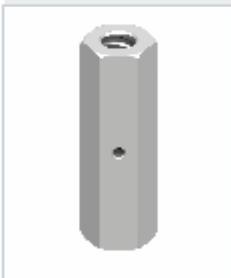
Шестигранная соединительная гайка изготовлена из автоматной стали 115sMn30+C, имеет резьбу совместимую с системой D&W. По середине длины гайки установлен стопорный штифт, который идеально подходит для продолжения соединений резьбовых стяжек. Навинчивается на стяжку ключом с храповиком или торцевым ключом. Нельзя сваривать.
