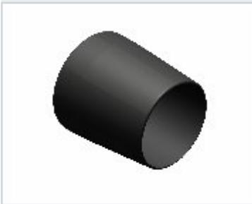
Пластиковая пробка вдавливается в бетонную трубу, имеющую внутренний диаметр 22 мм, и выполняет функцию упорного ложа для вклеиваемой бетонной пробки. Также выполняет функцию уплотнения. Полезным инструментом для монтажа пробок ПВХ в отверстие бетонной трубы является устройство для установки пробок.
