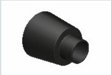
Пластиковый конус имеет большую поверхность, прилегающую к опалубке. Это предотвращает образование на поверхности опалубочных щитов повреждений, вызванных давлением. Для удобства монтажа и демонтажа служит ключ для конусов EX. Технологическое отверстие от конуса закрываются пробкой EX, которая фиксируется с помощью клея А+В.
