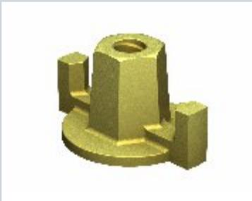
Дисковая гайка D70 отливается из ковкого белого чугуна, защищена цинковым покрытием. Имеет опорную поверхность диаметром 70 мм, заменяющую упорную шайбу. Навинчивается на стяжку ключом для барашковых гаек, ключом с храповиком или торцевым ключом.
