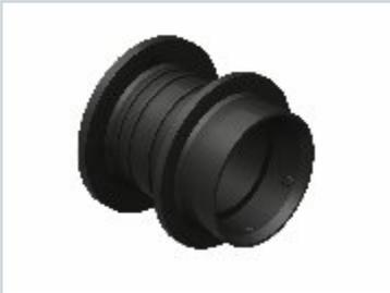
Наконечник, выполняющий функции конуса, изготовлен из пластика и используется для герметизации конца распорной трубки. Наконечник IN остается в бетоне и закрывается пробкой STOPF, что гарантирует герметичность перехода при небольшом давлении воды. Наконечник IN во время заливки очень плотно закрывает внутреннюю часть распорной трубки от попадания бетона и грязи на проходящую внутри стяжку.
