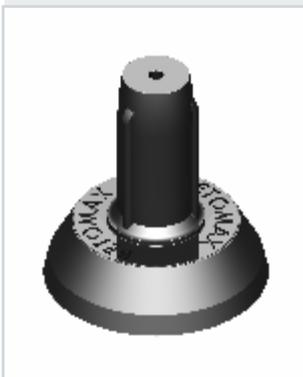
Анкерная втулка совместима с системой D&W. Изготовлена из пластика, усиленного стекловолокном. Отверстия в анкерной втулке CLIMAX используется для ее прикрепления с помощью вязальной проволокой к анкеровке главного элемента.
