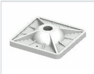
Шайба отлита из белого ковкого чугуна устойчивого к воздействию атмосферных факторов. Шайба предназначена для передачи напряжения, возникающего в результате давления бетона с пластин, посредством гайки на опалубочные стяжки. Ребра на поверхности шайбы увеличивают ее прочность.
