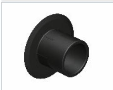
Пробка EX 22 для распорной трубы К 22 позволяет закрыть технологические отверстия от конусов. Используется в местах не подверженных воздействию давления воды для снижения расхода заполняющего раствора.
