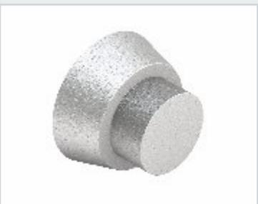
Пробка изготовлена из архитектурного бетона С30/37 армированного микроволокном с водонепроницаемостью W-8. Пробка приклеивается с помощью клея А+В на основе эпоксидной смолы. Расход клея около 150 шт/кг.
