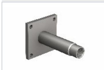
Изготовлен из анкерной плиты с приваренной втулкой с резьбой М 24. Перед прикреплением элемента к опалубке с помощью кронштейна М 24 следует анкерный элемент закончить наконечником IN 26. После распалубки к отвердевшей поверхности бетона прикрепляется, напр., леса, подмости с помощью болта М 24x70. После завершения работ отверстия следует заглушить пробкой STOPF 26.
