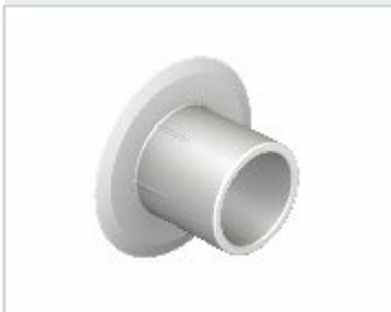
Прокладка для конца бетонной трубы FB изготовлена из пластика. Защищает опалубочную стяжку и внутреннюю часть распорной трубы от загрязнения бетоном. Выполняет функцию конуса, закрывающего конец распорной трубы, являющийся опорой между распорной трубой и опалубочным щитом. После распалубки прокладка для конца бетонной трубы удаляется, а образовавшееся отверстие заполняется и выравнивается заполняющим раствором.
