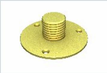
Кронштейн изготовлен из металла, с его помощью можно прикрепить конус SKK и анкерный элемент M24. В первую очередь необходимо прибить кронштейн к опалубочному щиту, затем ввинтить конус SKK либо анкерный элемент M24 на резьбу кронштейна.
