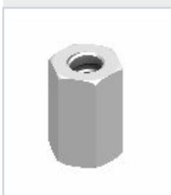
Шестигранная гайка используется вместо барашковой гайки и изготовлена из нержавеющей стали S355J2C+C (в соответствии со старым стандартом ST52-3), имеет резьбу совместимую с системой D&W. Гайка идеально подходит для работы в труднодоступных местах. Навинчивается на стяжку ключом с храповиком или торцевым ключом. Ее можно сваривать.
