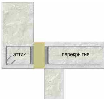
Соединитель КР-900 используется в месте консольного соединения балконной плиты с плитой перекрытия - передача изгибающих моментов  $MR_d (\pm)$  и сил сдвига  $VR_d (\pm)$ . Арматурные стержни из нержавеющей стали.
