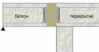
Соединитель KP-600 используется в месте шарнирного соединения балконной плиты с плитой перекрытия - передача сил сдвига  $VR_d(+)$ . Арматурные стержни из нержавеющей стали.
